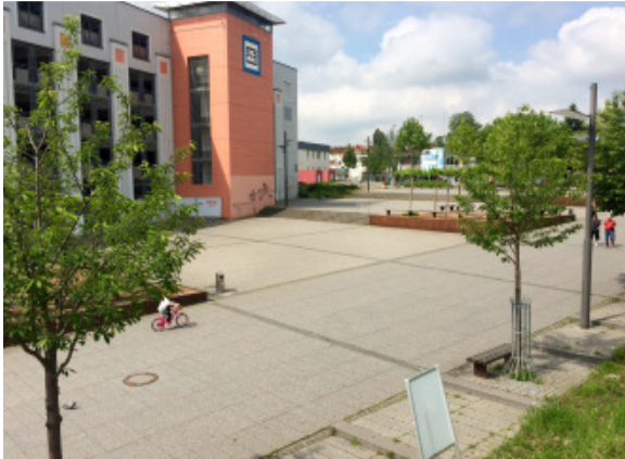
Abb. 41. Auxerre-Platz am Wormser Hauptbahnhof: Infolge der durchgängigen Versiegelung kann Niederschlagswasser nicht versickern, © Stadt Worms.
