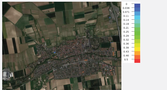
Pfeddersheim – Maximal auftretende Wassertiefen
